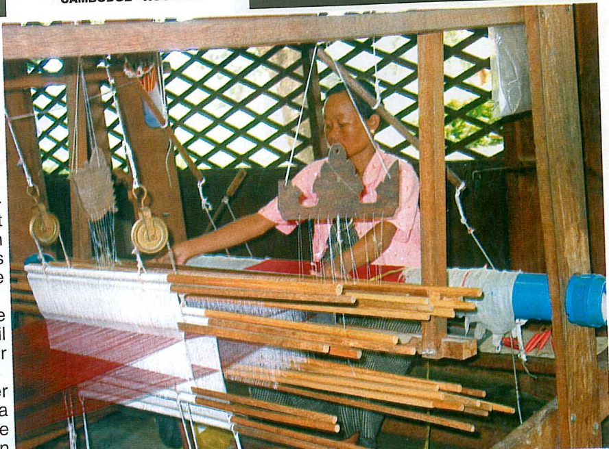
Tissage: on voit les deux couches de la chaîne. Pour les pièces larges, la navette est lancée par des poignées et un renvoi de poulies. Des crochets soulèvent alternativement certains fils pour réaliser un motif.
