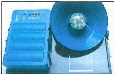
Sur un panneau solaire photovoltaïque de 18cm x 15, on voit les batteries au lithium avec contrôleur de charge, et une lampe avec ampoule led à haute luminosité. Les branchements se font directement du panneau solaire à la batterie et de la batterie aux appareils électriques. Le tout pèse moins de 1 kg.
